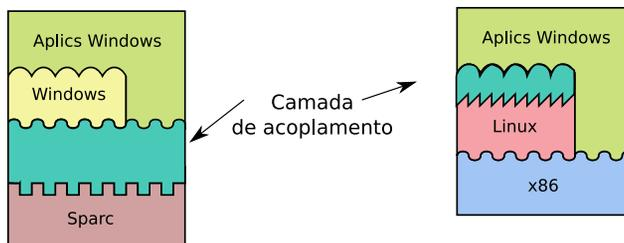
**Figura 4.5. Acoplamento entre interfaces distintas**
